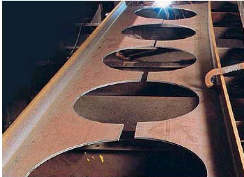
Figura 2 – Exemplo de fabricação de uma viga celular Fonte: http://www.asdwestok.co.uk/ - acessado em: 05 maio,2015.
